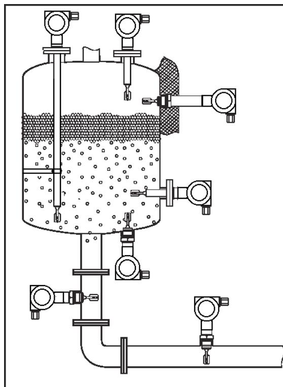
Рисунок 6. УСТАНОВКА ВИСУР С ЗАЩИТНОЙ ТРУБКОЙ
