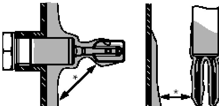
10.6 ВИСУР с резьбовым креплением может уплотняться лентой ФУМ или специальным кольцом (см. рис. 10). ВИСУР с фланцевым креплением устанавливается на прокладке из паронита или фторопласта.
