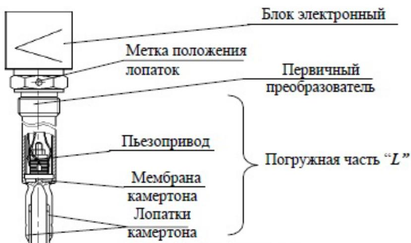
4.1.2 Первичный преобразователь представляет собой корпус в виде трубы из нержавеющей стали, с закрепленным в нем пьезоэлементом, который жестко соединен с вибрирующим камертоном, состоящим из мембранны и лопаток.
